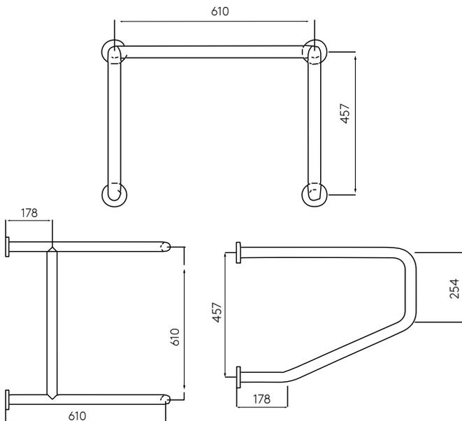
Barra de seguridad con sujeción doble a la pared en acero inoxidable satinado, tornillos ocultos. Importado AyA.
